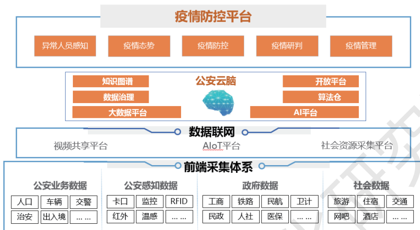
图7-1 基于公安云脑的疫情防控系统整体架构图
